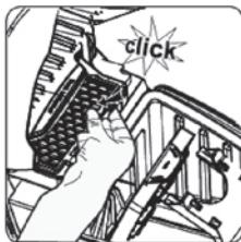
Setzen Sie das HEPA in die Maschine und drücken Sie, um es zu fixieren
